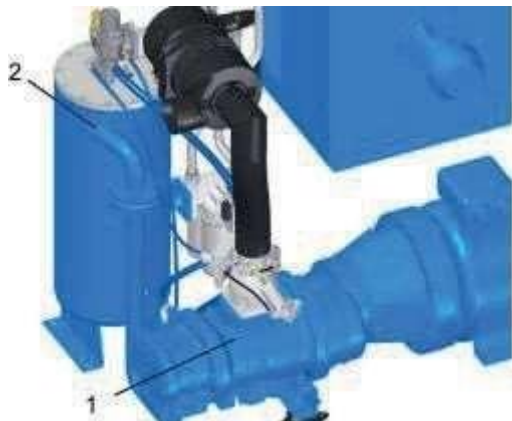
Рис. 7: Винтовой блок компрессора
