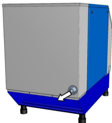
Рис. 20: Подключение сжатого воздуха
